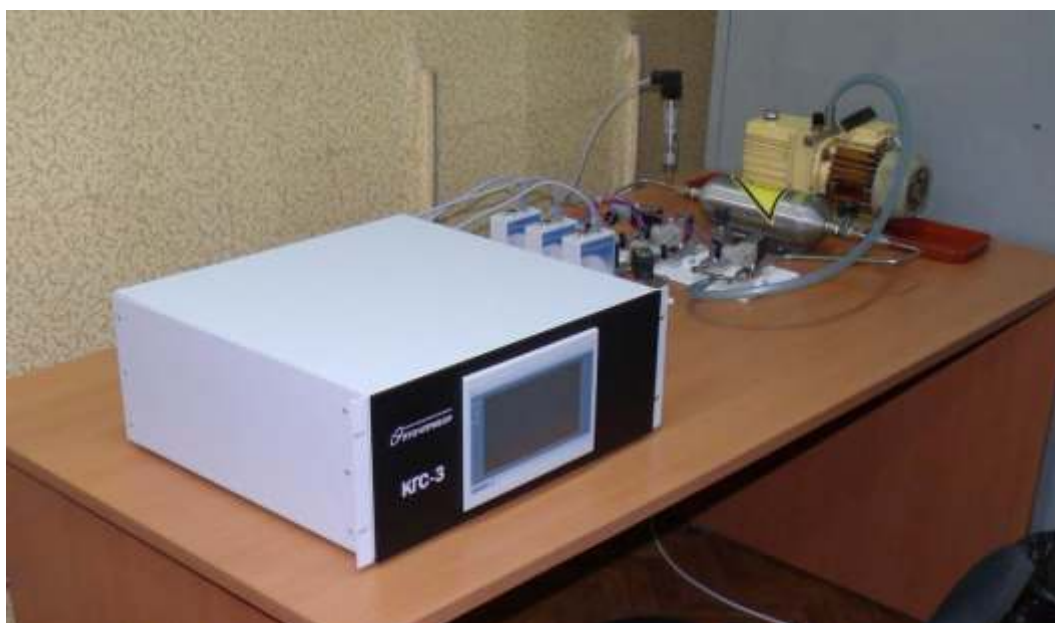
Рис.1. Контроллер газовой системы КГС-3 и газовая система.
