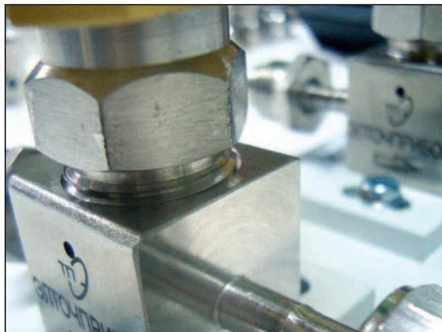
Рис. 1б. Вид сварного шва
