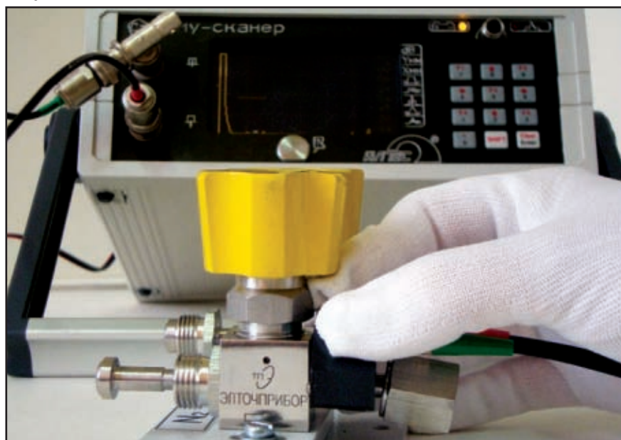
Рис. 2. Проверка качества сварного шва ультразвуковым дефектоскопом
