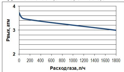
РДМ-25Н: вход 2,0 МПа, выход 0,3 МПа
