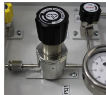
РДМ-25Н-5-5-0 установлен в газовой панели с низким давлением газа (вариант исполнения: без штуцеров для сварного соединения с трубопроводом)
